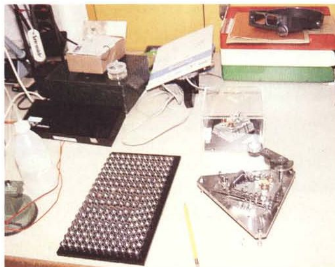
Su un tavolo nel laboratorio di fisica due diverse versioni del microscopio STM, accanto ad uno strano dispositivo a palline metalliche grazie al quale si può modellare la struttura superficiale della materia per meglio comprenderne le proprietà.
